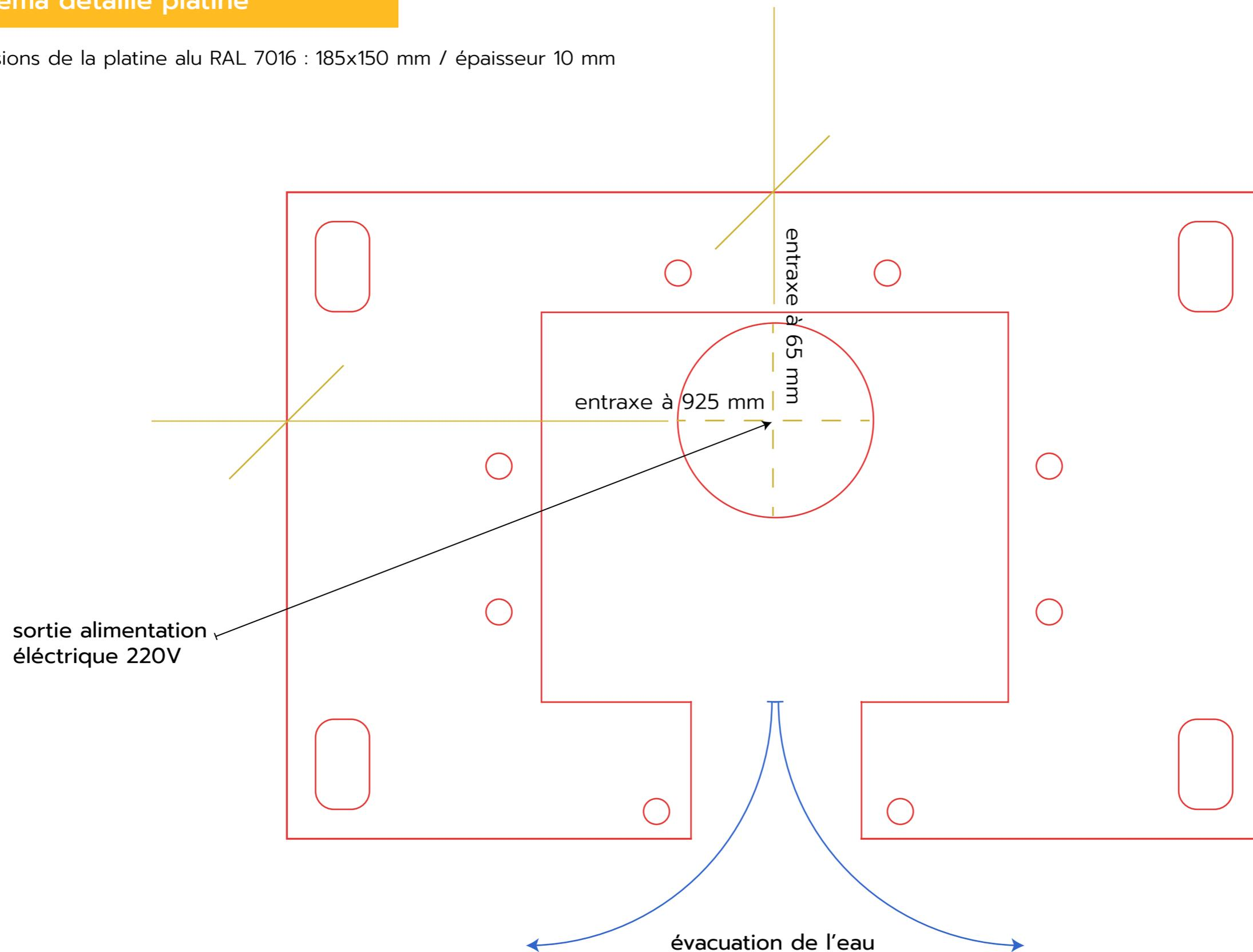
Toutes les platines doivent être positionnées de façon à avoir l'évacuation de l'eau vers l'extérieur de la pergola
